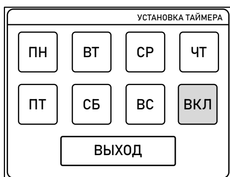
Рисунок 21 - Экран меню установки таймеров
