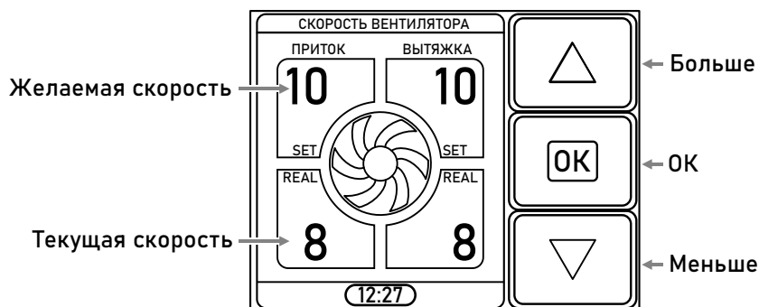
Рисунок 18 - Экран выбора скорости вентилятора
